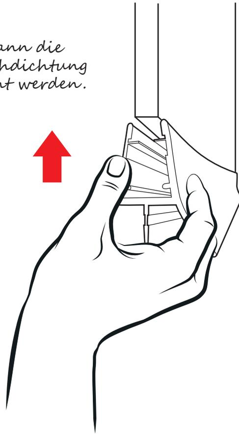
Dazu muss die Dichtung von unten mit dem Profil auf die Glaskante geschoben bzw. gesteckt werden, bis das Profil sicher sitzt. Dabei sollte das Profil der Länge nach vollständig anliegen.
